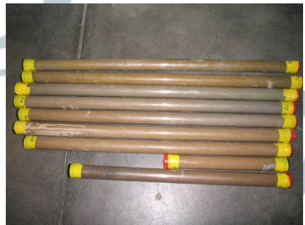
Foto 4: Ongeroerde grondmonsters genomen met Liners ten behoeve van de Red Oil test.
