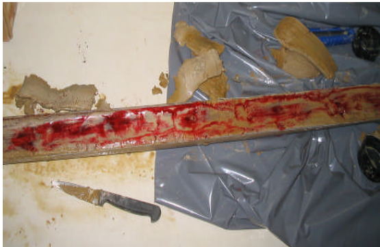
Foto 5: Toetsing op de aanwezigheid van puur product (= optreden van rode verkleuring)
